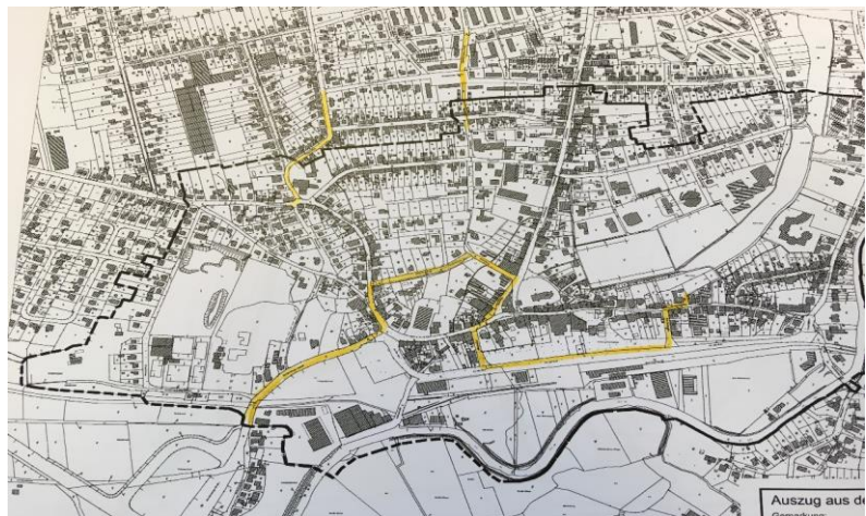
Abb. 220: im Gebiet erfolgte und für 2020 geplante Auswechslung von Mittelspannungsleitungen (gelb). Darstellung: Schleswig-Holstein Netz AG
