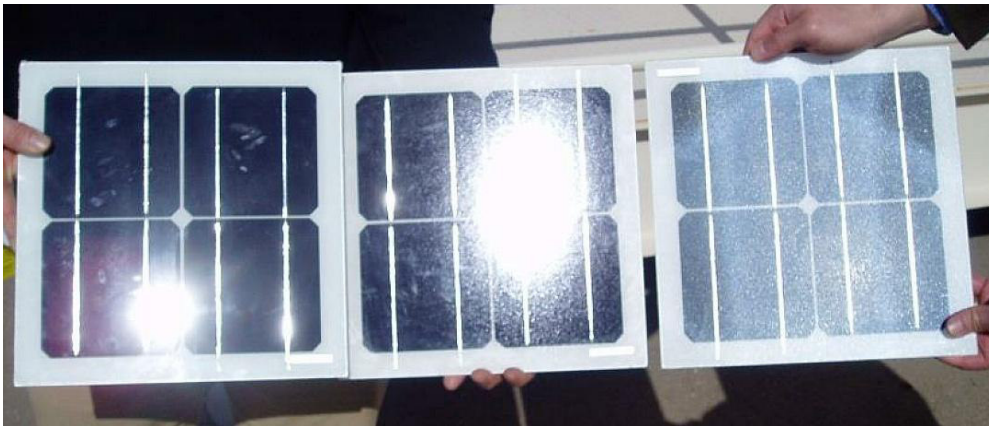
Bild 3.2.3: Diffuse Reflexion von unterschiedlichen Moduloberflächen (Quelle: Sandia National Laboratories)
