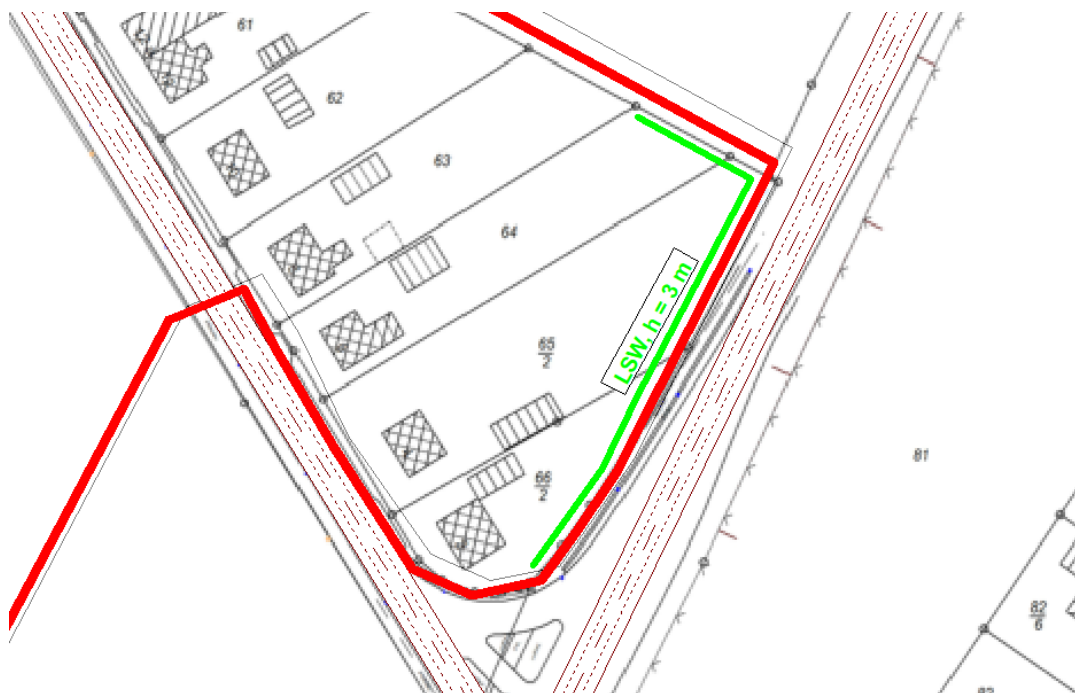
Abbildung 3: LSW parallel zur Kieler Straße mit einer Länge von insgesamt 105 m, mit einer 23 m langen Abwinkelung am nördlichen Ende der Wand Richtung Westen.
